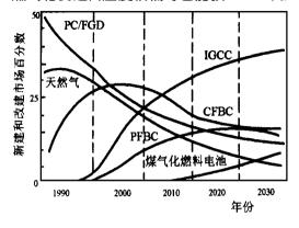
PC/FGD一带有尾气脱硫装置的燃煤汽轮机电站 PFBC一增压流化床联合循环电站:
